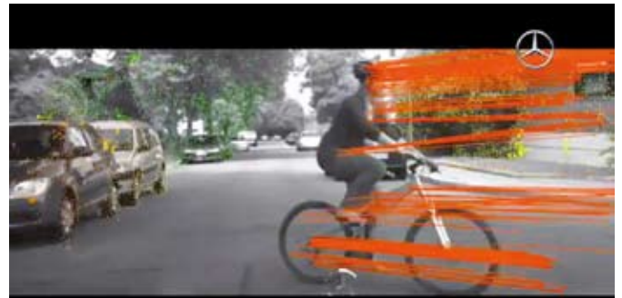
A 6D rendszer kijelzőjén a jármű előtti álló vagy mozgó akadályokat vörös színezéssel jeleníti meg. A hirtelen keresztbe forduló kerékpárosra élénkpiros szín hívja fel a figyelmet
