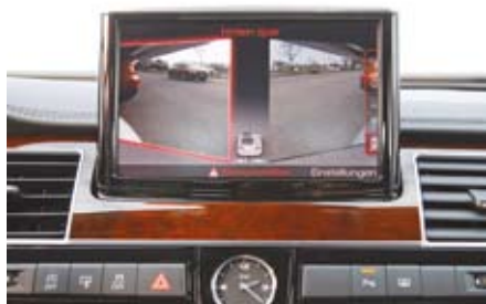
A keresztirányú forgalmi asszisztens műszerfali kijelzőjén a bal oldali és jobb oldali forgalom képe együtt látható
