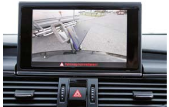
A lakókocsit vontató jármű (a) műszerfali kijelzőjén a vezető folyamatosan megfigyelheti a vonórúd elfordításának mértékét (b)
