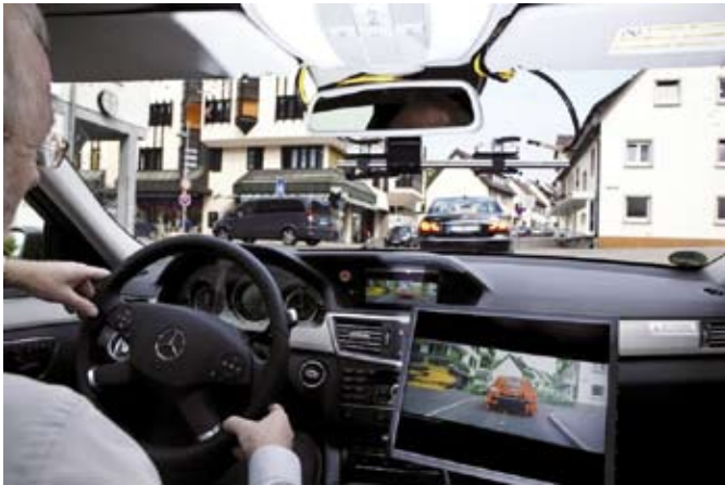
A 6D rendszer kijelzőjén a jármű előtti álló vagy mozgó akadályokat vörös színezéssel jeleníti meg. A hirtelen keresztbe forduló kerékpárosra élénkpiros szín hívja fel a figyelmet
