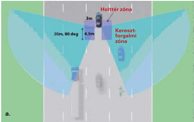
A keresztirányú forgalmi asszisztens érzékeléstartomány (a) és használata, parkolóból való kitolatkör (b)
