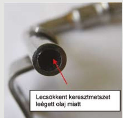
Az olajbevezető cső metszete
