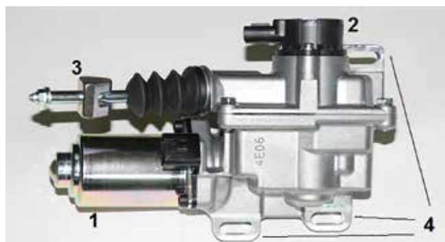
❶ Kuplungmozgató motor. 1 – állítómotor, 2 – helyzetérzékelő, 3 – vonórúd a kiemelő villához, 4 – felfogatási pontok
