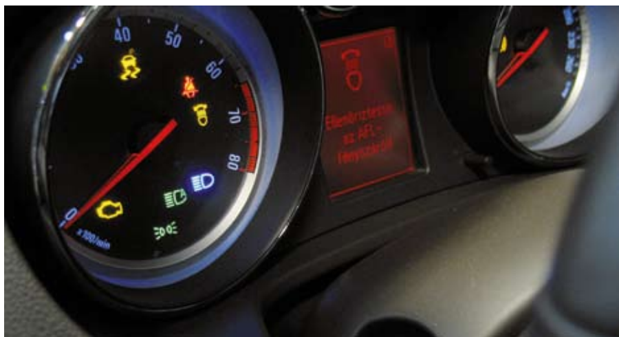
Az AFL műszerfali visszajelzőfények piktogramjait és azt a feliratot látjuk, miszerint az AFL-lel aktuálisan nincs minden rendben
