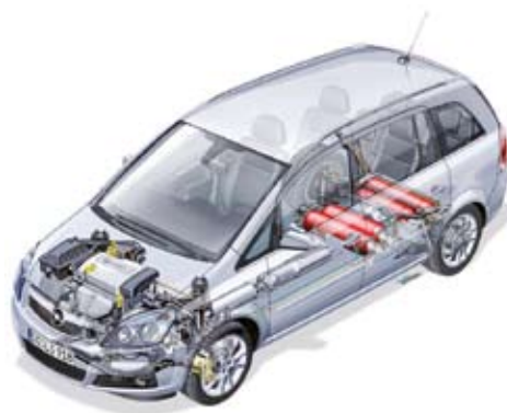
Az Opel Zafira CNG, 200 bar nyomású földgáztartályait a jármű hátsó ülése alá telepítették
