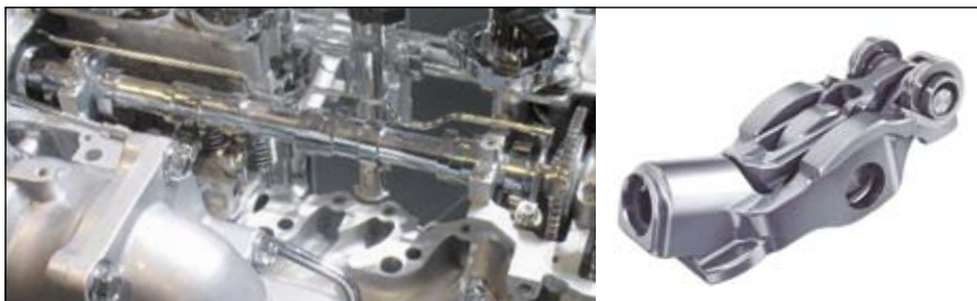
7. ábra: kipufogó-vezérműtengely bütyökkontúr és szelephimba
