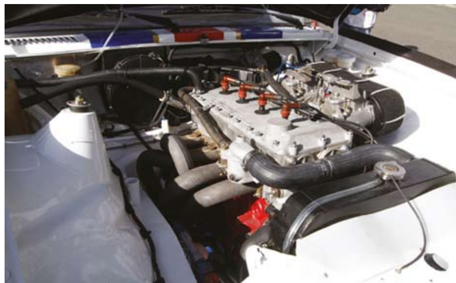
A motor olajbeöntő nyílás „stucnija” a szelepfedélen zárt, ez a „szárazkarterre” utal
