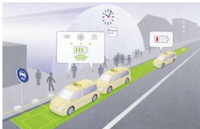
A kábelcsatlakoztatást nem igénylő indukív töltőállomások jól beilleszthetőek a városi utcák szélső közlekedési sávjába
