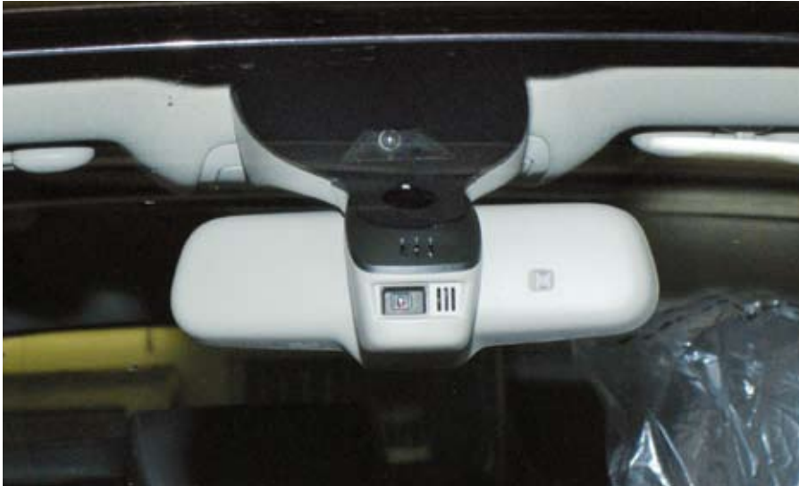
Érzékelőmodul: elöl az aktív világítás kamerája, felette az eső- és fényérzékelő, felül (bal oldali kép) a sávfigyelő kamera. Az érzékelőmodul klímaérzékelőket is tartalmazhat (légnedvesség, hőmérséklet)
