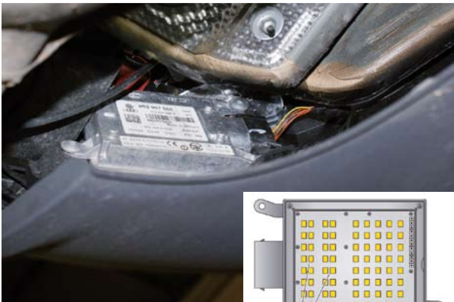
A hátranzó holttérfigyelő és sávval-tás-asszisztens radaregysége a hátsó lökhárítóban
