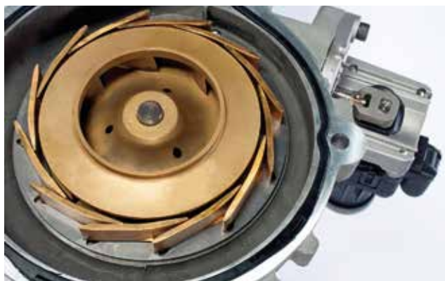
13 Állítható lapátszögű, hasznójárművekbe szánt hűtőfolyadék-szivattyú a KSPG-től.
