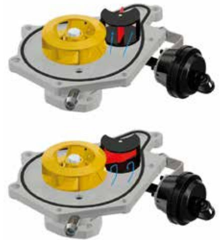
3 A Saleri által fejlesztett, pillangólap-pal szabályozott hűtőfolyadék-szivattyú nyitott és zárt állapotban
