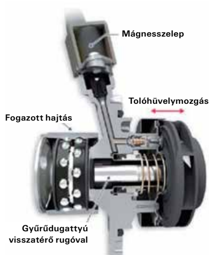
6 A VW tolóhüvelyes szivattyúszabályozása
