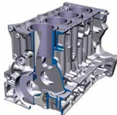
1 Egységes a hengertömb felépítése, mindegyik motor bed plate-es kialakítású, alumíniumöntvényből készül, megegyezik a hengertávolságuk, furatuk és löketük.
