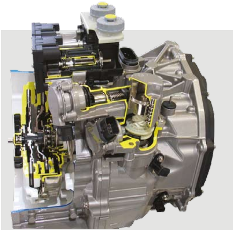
4 A Honda „i-DCD” kéttengelykapcsolós váltója, a váltóház tetején a két HCA (INA), a váltó oldalán a fokozatkapcsoló-beavatkozó (LuK)
