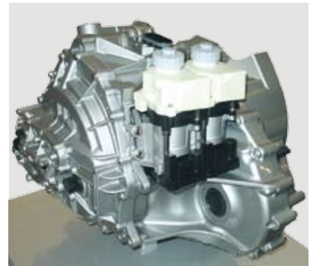
7 Az „SH-AWD” sebességváltóra szerelt tengelykapcsoló-működtető HCA-egységek
