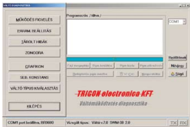
A munkahengerek és a szelepek diagnosztizálására szolgáló menü
