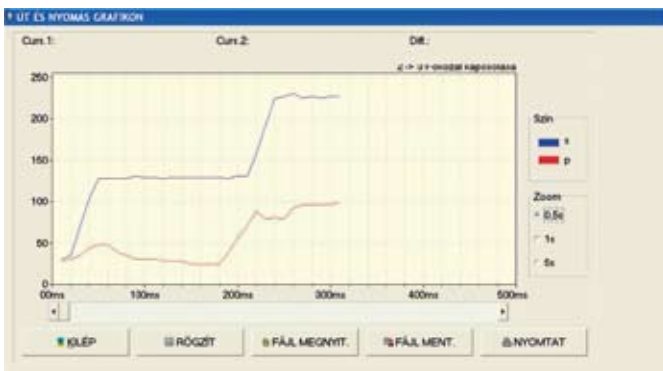
A sebességváltás (fokozatkapcsoló henger elmozdulása) idő-elmorzulás, illetve idő-nyomás (kapcsolóerő) diagramjának felvétele
