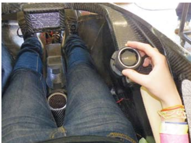
19 A kormánykerék a pilótafülke oldalán van, nem zavarja a kilátást
