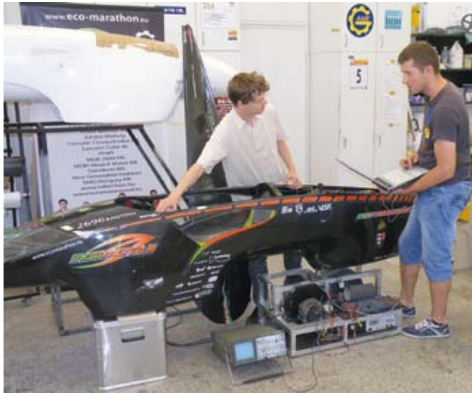
24 Görgős fékpadon az Mm-III versenyjármű
