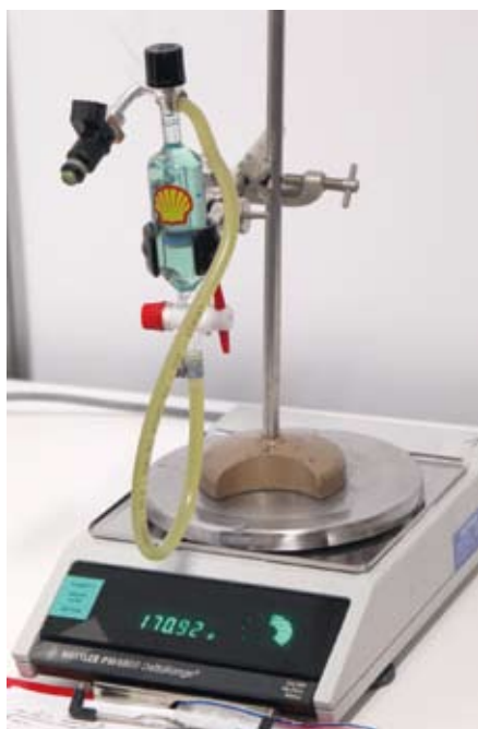
1 Az elfogyasztott benzin tömegét analitikai mérleggel mérik
