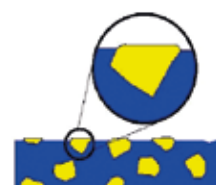
3 Süllyesztés mechanikai megmunkálással, hónolással, a szilíciumkristályok szélei lekerekítettek
