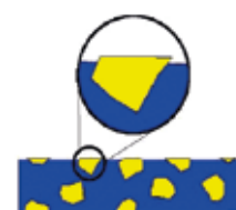
2 Süllyesztés kémiai maratással, a szilíciumkristályok szélei élesek
