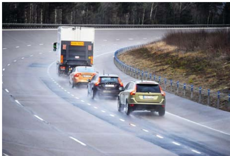
A Volvo járműoszlopában a kisebb légellenállás 5-15% üzemanyag megtakarítást teszi lehetővé
