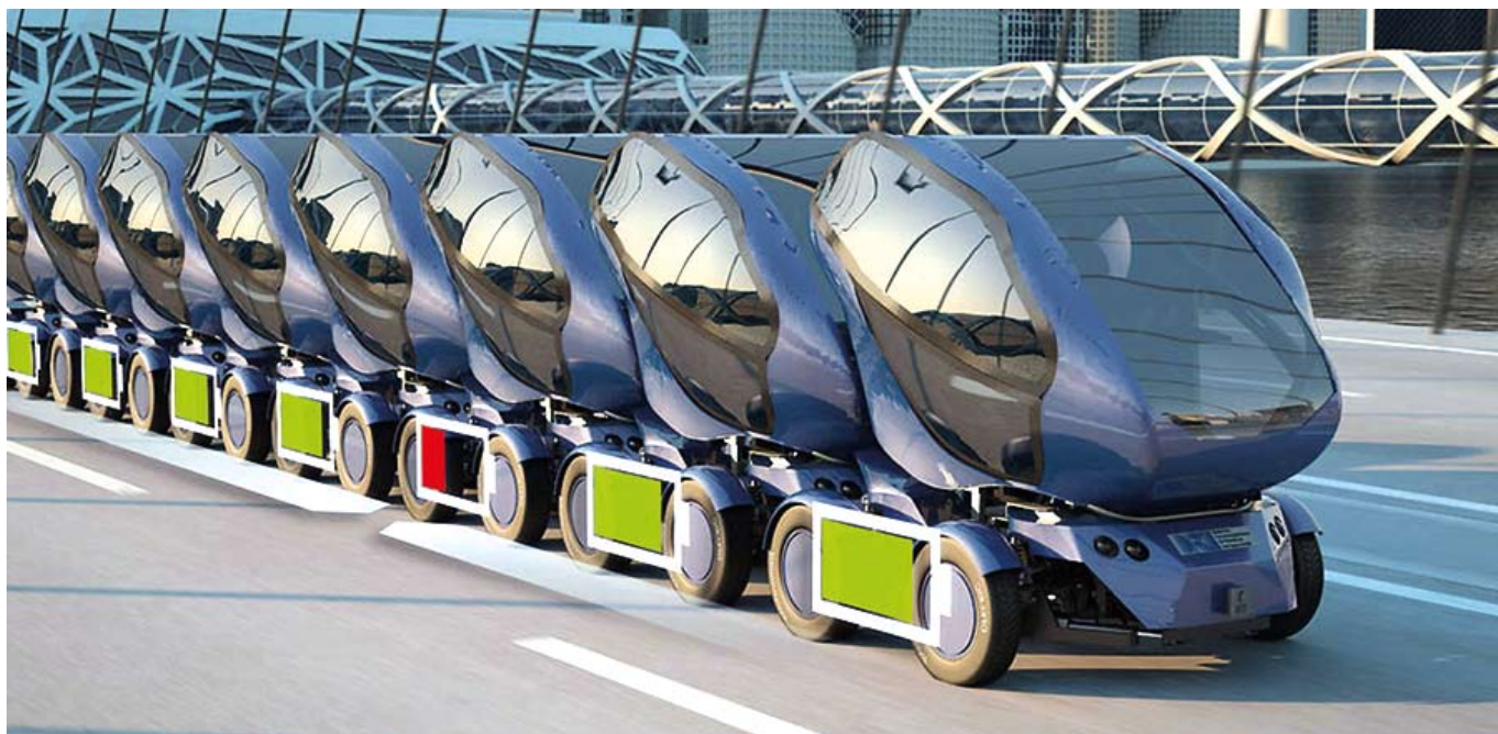
Az egy ülés szélességű gépkocsik a háromszorosára növelhetik az autópályák átbocsátó képességét. A bevásárlókocsikhoz hasonlóan egymásba tolható változataik a negyedére csökkenthetik a városi gépkocsik parkolásihely-igényét
