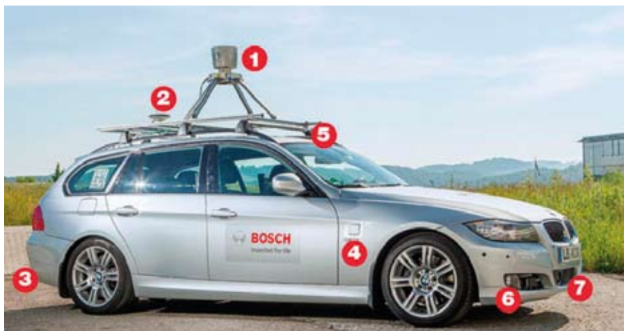
A Robert Bosch boxbergi kísérleti pályáján próbálgatja sok érzékelős robotautóját. 1. Lézerszkennő. 2. GPS-antenna. 3. Hátsó, 4. oldalsó megfigyelést végző radar. 5. Első megfigyelést végző sztereo kamera. 6. Első megfigyelést végző közeli, 7. távoli radarérezkélő
