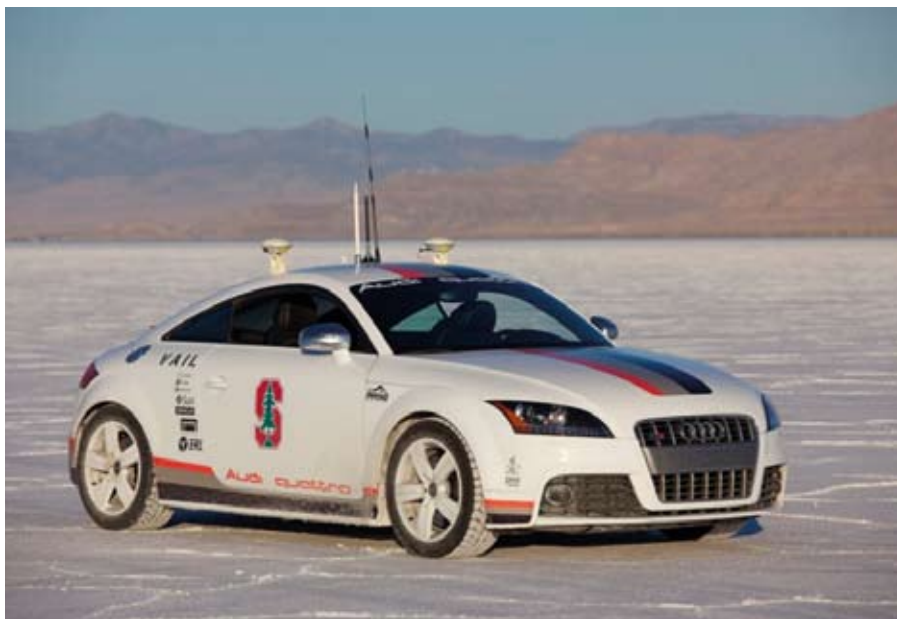
Az Audi a Bonneville-i tó sóburkolatán és a Pikes Pike szerpentinjein, a Stanford Egyetem színeiben tesztelte GPS-antennás, TTS robotkupéját
