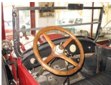
A kormányon kézi gáz és kézzel állítható előgyújtás található
