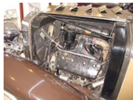
A motor lökettérfogata 5793 cm 3 , V8, OHV, 115 LE
