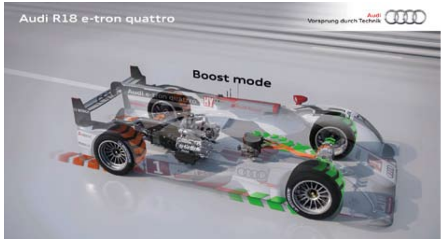
2 Quattro módban a hátsó kerekeket a belső égésű motor, az elsőket az elektromotorok hajtják
