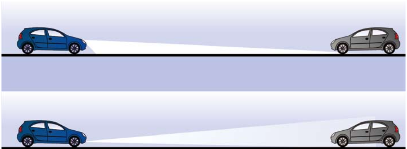
4 A jármű „kivilágítása” a felső képen tompított fényszóróval, az alsó képen nappali menetjelző lámpával
