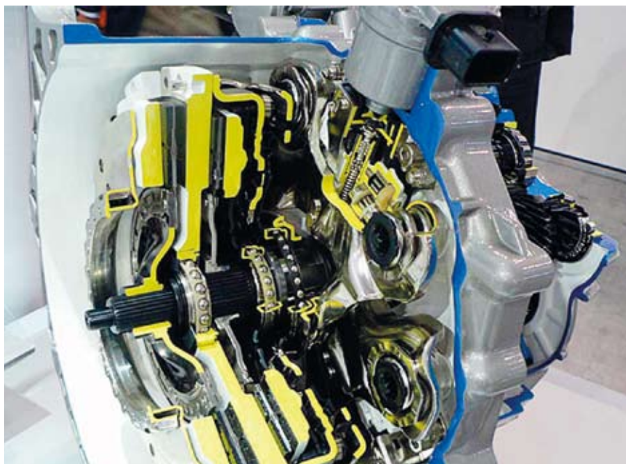
5 A 6DCT250 száraz tengelykapcsolója (LuK)
