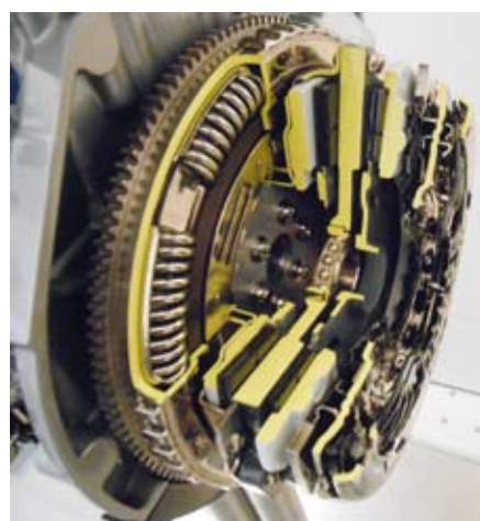
6 A Ford 3-hengerű EcoBoost-motorjához is rendelhető Getrag PowerShift váltó, LuK tengelykapcsolóval
