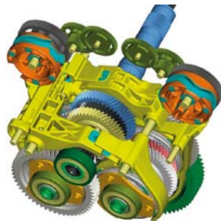
4 A 6DCT250 fokozatkapcsoló-szerkezete
