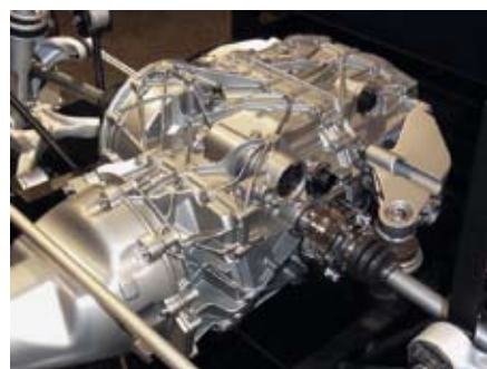
1 A transaxle elrendezéshez tervezett nagy teljesítményű 7DCL750
