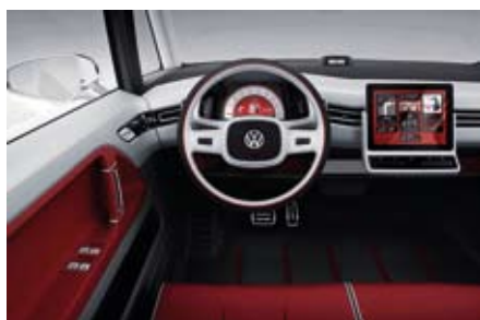
A VW Bulli kommunikációs eszköze egy tartótokba ágyazott és onnan kiemelhető táblagép (tablet)
