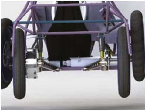
3 A hátsó futómű és a motor a bal kerékagyban
