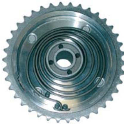
14 A lengő hidromotor alaphelyzetbe állító spríálrugója
