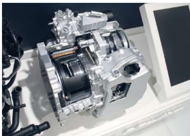
A TwinDrive DSG váltóval kombinált villanymotorja
