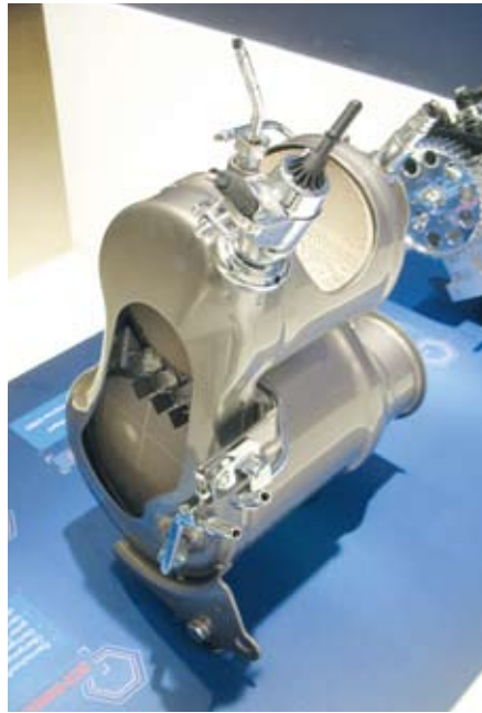
13 AdBlue keverőtér az átömlőcsatornában
