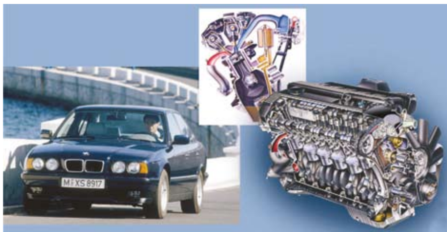
❶ BMW 520i, motor: M50B20TU, hengereként 4 szelep, DOHC, szívósori VANOS (1992)
