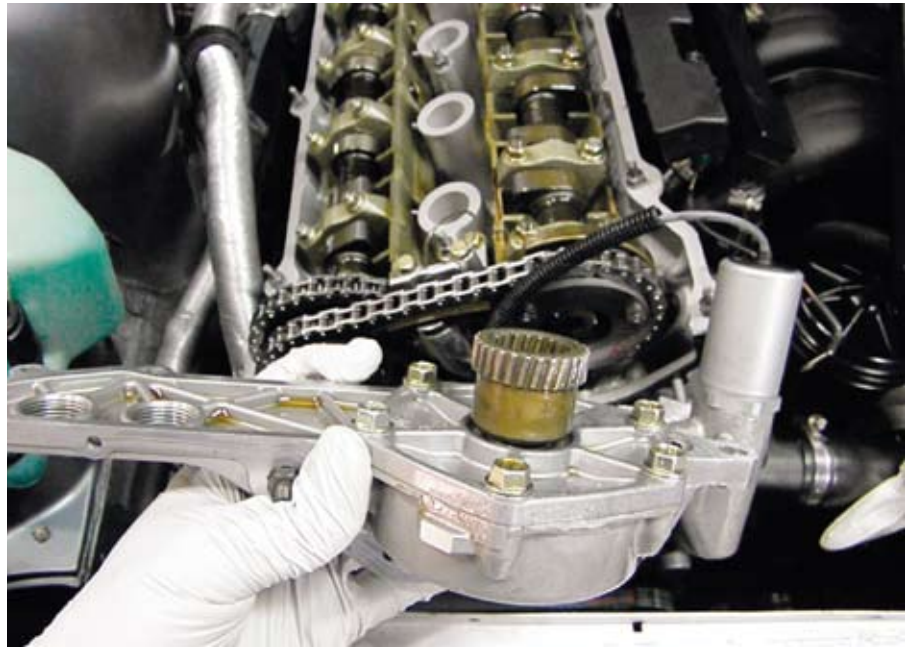
5 A beavatkozóegység (állítómű) a ferde fogazású tolóhüvellyel
