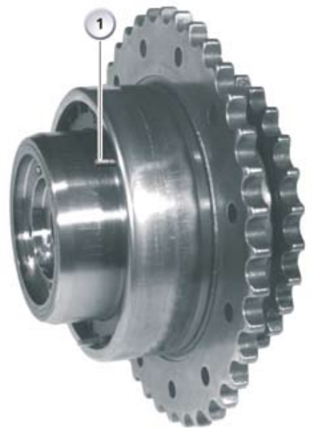
7 Lánckerék a végállás-érzékelő kontakt érintkezővel (1)
