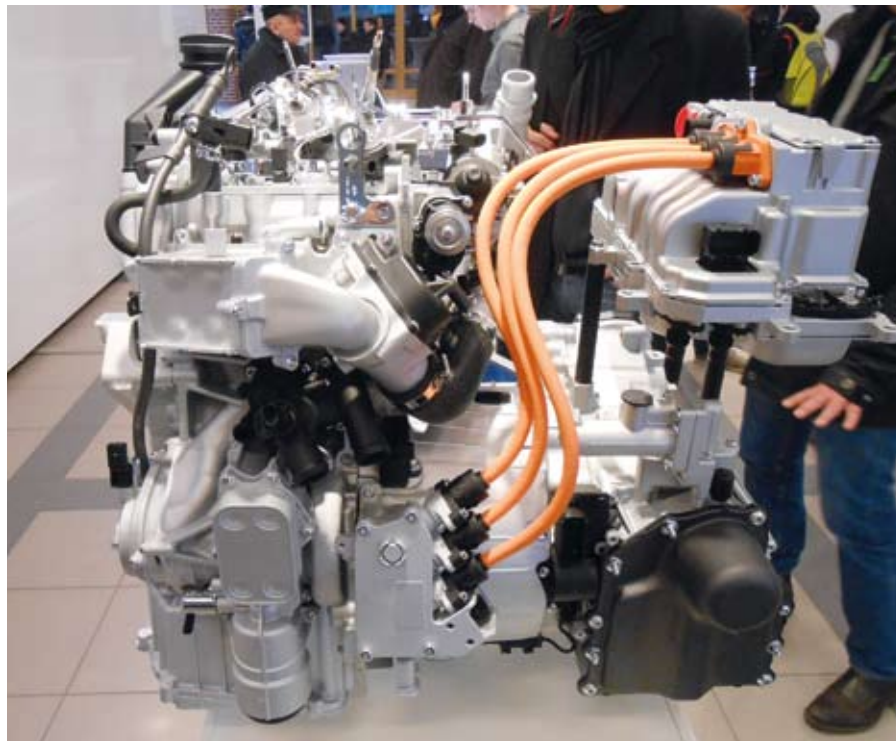
Az autó mozgatóját a 0,8 TDI motor és egy 20 kW-os villanymotor végzi a 7 sebességűes DSG váltón keresztül
