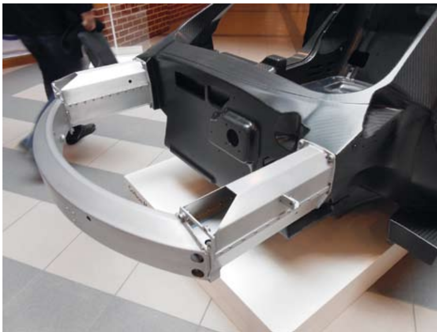
Az első nyúlvány és a crashbox is csavarozva vannak egymáshoz, a profilt szegecsekkel rögzítették, kevés a hegesztési varrat
