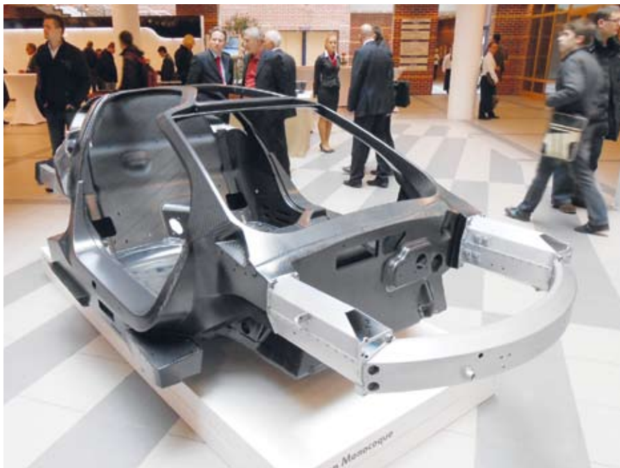
A karbonszálás monocoque mindössze 89,6 kg-ot nyom, a nyúlványok és tartók alumíniumból készülnek és csavarozva vannak az utastérhez
