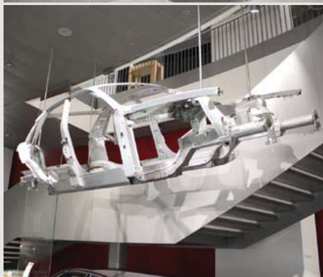
Audi AFS (Audi Space Frame) Concept Car 1993-ból, mely az A8 előfutára és alumíniumkarosszériája
