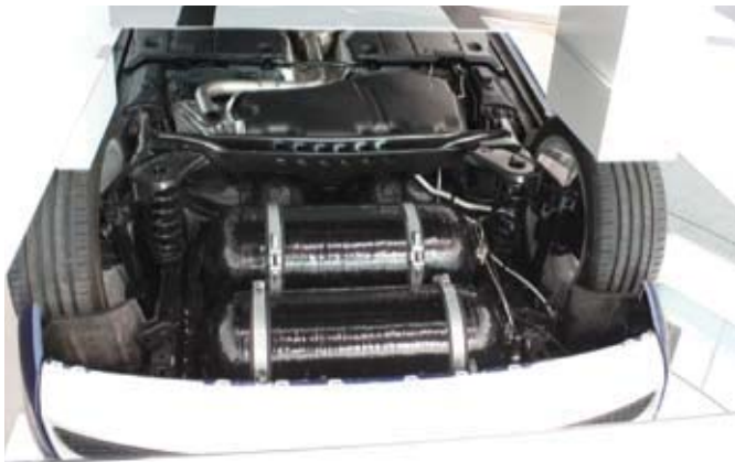
4 Audi A3 Sportback TCNG tartályai és hajtásláncmodellje 2012
