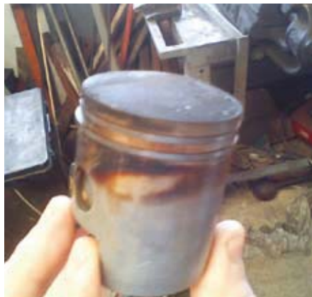
2 Utángyártott dugattyú, látszik, hogy a gyűrűnél átfúj
