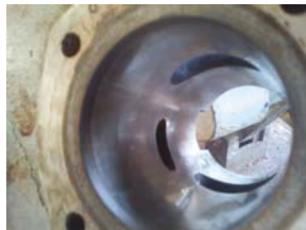
5 A henger: szemmel látható a váll és a gyűrűk nyoma
