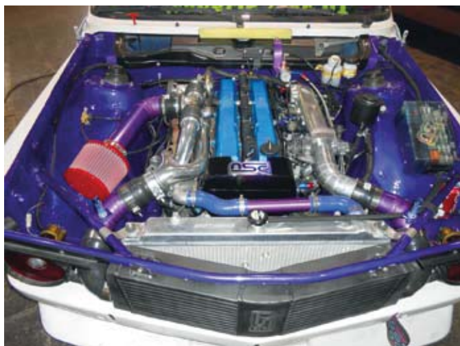
Egy versenyautónál a stílus és praktikusság egyaránt fontos, így kerülhetett az E21-es BMW elejére a hűtőrács alakot felvevő, egyedi intercooler
