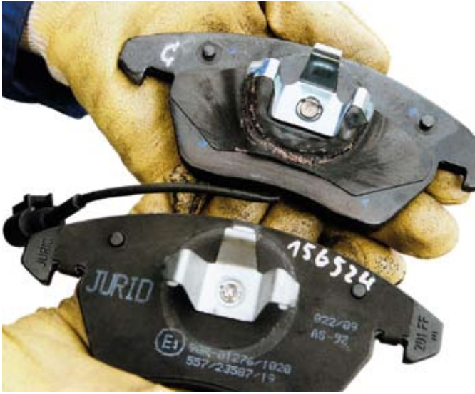
Az olcsó (felső kép) és a minőségi fékbetét közötti különbség a minősítő vizsgálatokon azonnal kiderül, de szemre is látszanak az „elspórolások”
