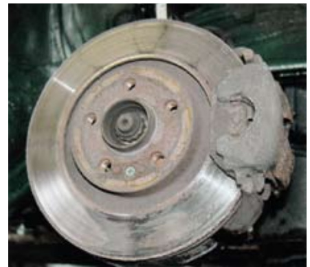
❶ A tárcsáról leváló rozsdadaréscsökkék a súrlódó anyagba beépülnek, növelve a fékezési zajt és a fékerő-ingadozást
