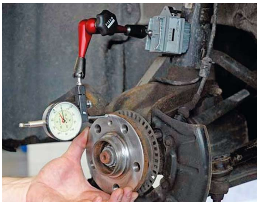
3 Tengelycsonkütés ellenőrzése mérőórával (Fotó: Linzing)
