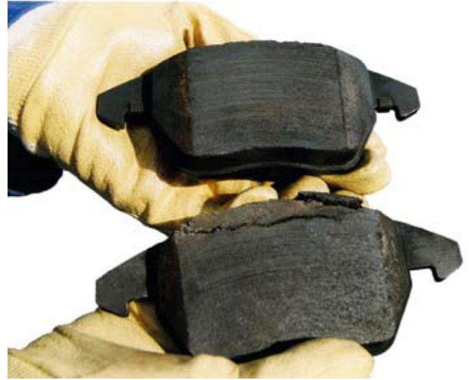
A fékbetét súrlódóanyagában is nagy különbség van az olcsó és a minőségi termék között. Az alsó képen egy olcsó termék roncsolódása látható tíz egymás utáni, 100 km/h sebességről való intenzív fékezés után, míg a minőségi jó állapotot mutat
