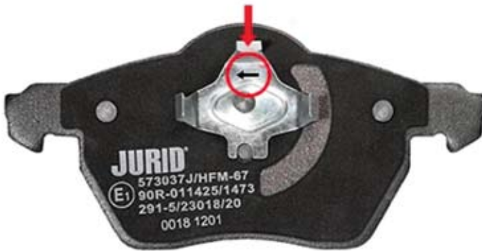
4 Forgásirányt jelző nyíl a fékbetéten
