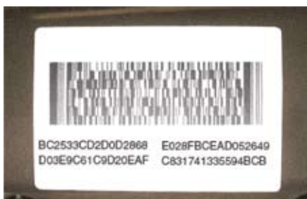
7 Injektorkódcímke befecskendezési sorrendnek megfelelően (1-3-4-2, első sor 1-3, második sor 4-2)
