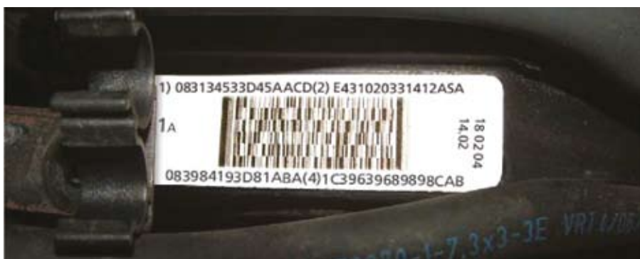
6 Injektorkódcímke fizikai hengerszámozásnak megfelelően
