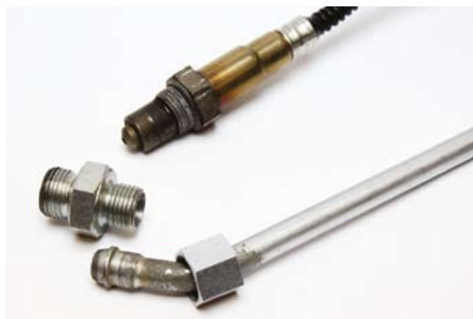
Adapter a szonda helyén való mérésre
