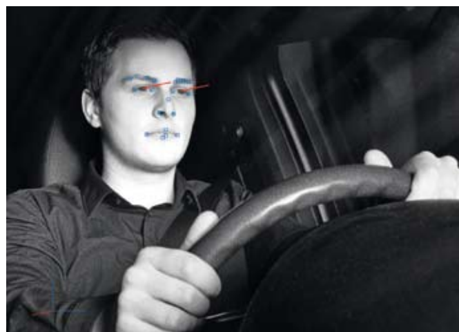
2 A kamera az arc bizonyos karakteres részeit figyeli, amelyből meg tudja állapítani, hogy a sofőr milyen irányba néz
