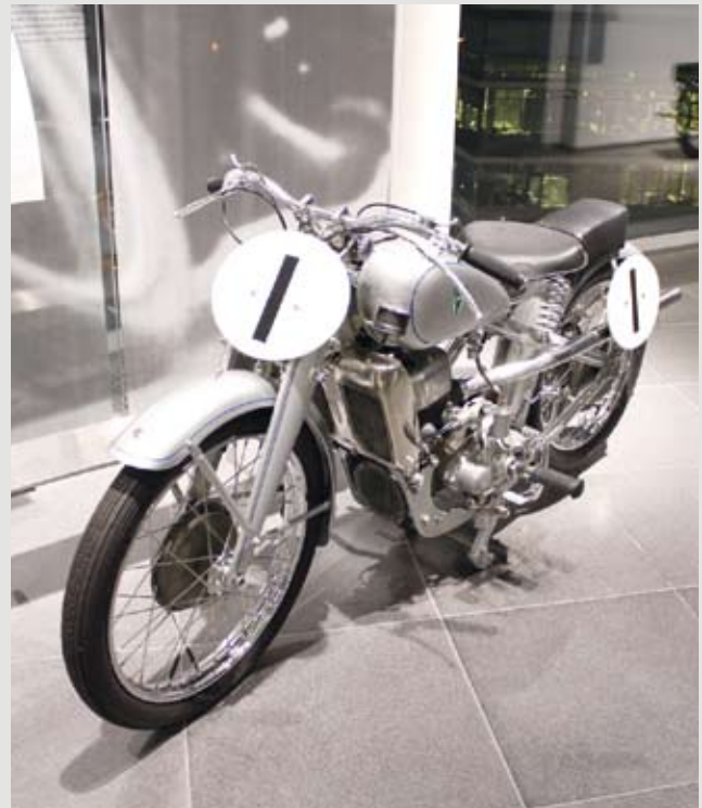
13 DKW US 250 kéthengeres kétütemű ikerdugattyús kompresszoros 35 lóerős motorral, melyből összesen 3 darab készült (1939)
