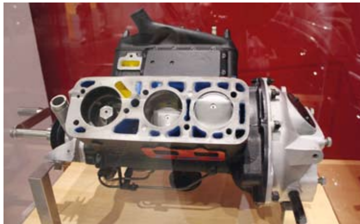
8 b A DKW Schwebeklasse V4-es kétütemű kompresszoros motorja
