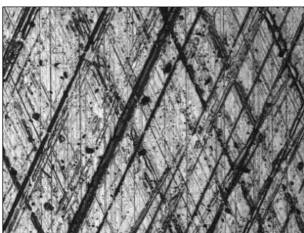
10 11 12 A spirálhónolt hengerfelület kiindulási, 40 és 140 órás kopott állapotáról készített lenyomat képe
