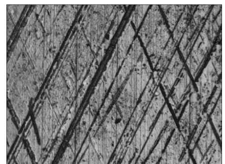
10 11 12 A spirálhónolt hengerfelület kiindulási, 40 és 140 órás kopott állapotáról készített lenyomat képe
