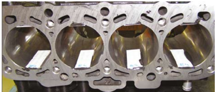
❶ Szilikonlenyomat készítése a hengerfelületről
