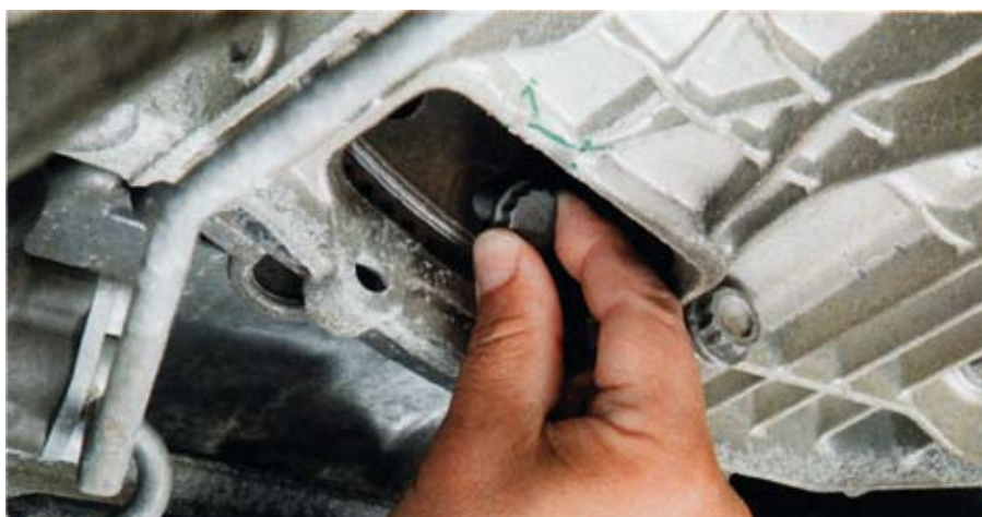
12 A váltó/kuplungkarang egység motorral való összeszerelése után csavarozzuk össze a tengelykapcsoló-modul alakos hajtótárcsáját a motor főtengelyéhez rögzített menesztőtárcsával, 3 vagy 6 csavar segítségével
