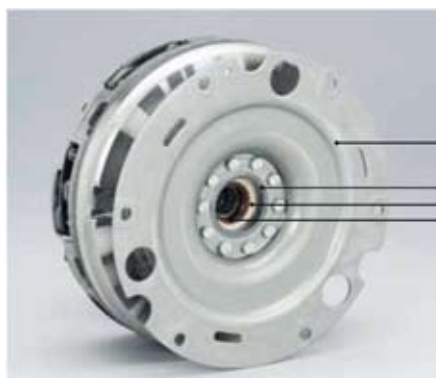
9 A menesztőtárcsa és a vele kapcsolódó tengelykapcsoló modul szerkezeti elemei
