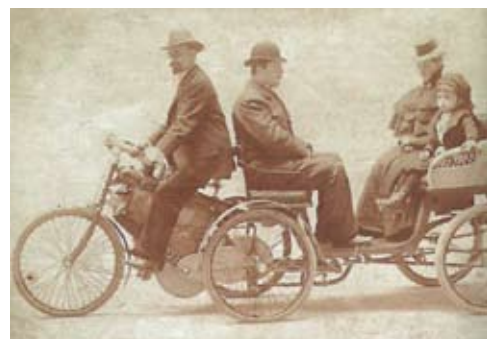
Heinle & Wegelin gyártmányú utánfutós triciklit 1897-ben már az új Bosch „lengő fémhüvelyes” kisfeszültségű mágnesgyújtással látták el
