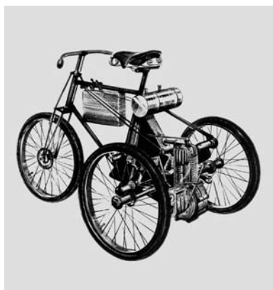
A de Dion-Bouton tricikli, mely először kapott mágnesgyújtást
