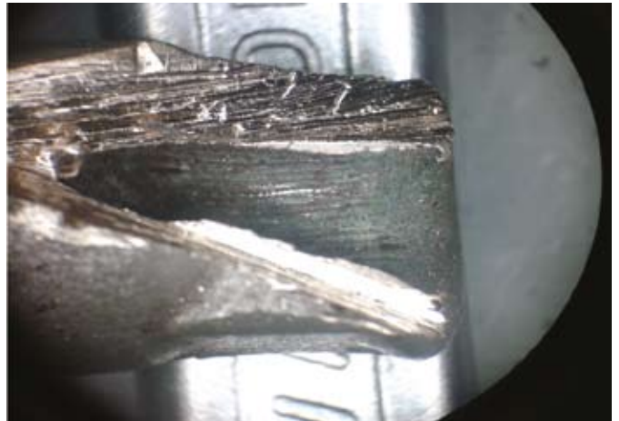
4 Nagyító alatt azonban jól látható az erős korrózió
