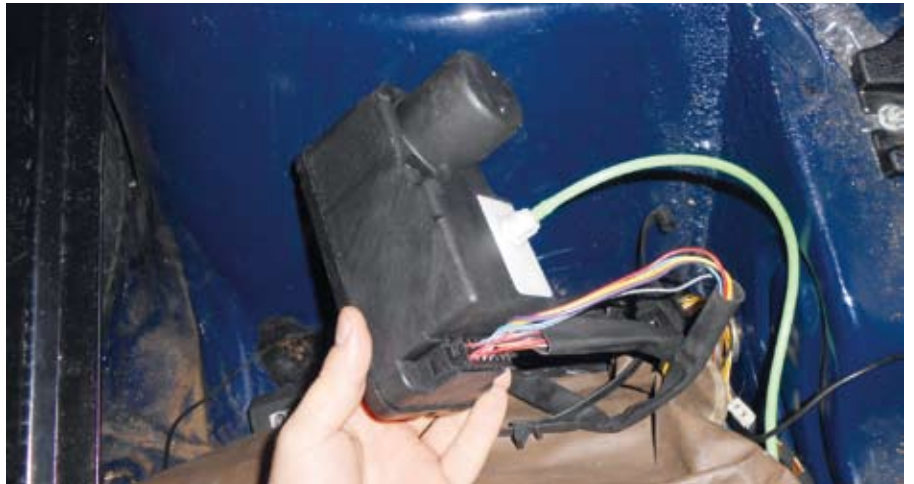
1 A helyéről kibontott zárszivattyú
