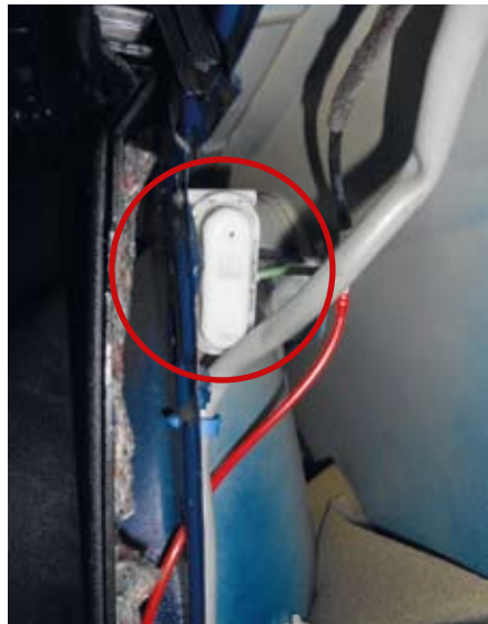
2 A tanksapkafedél-záró aktuátor elhelyezkedése a karosszérián
