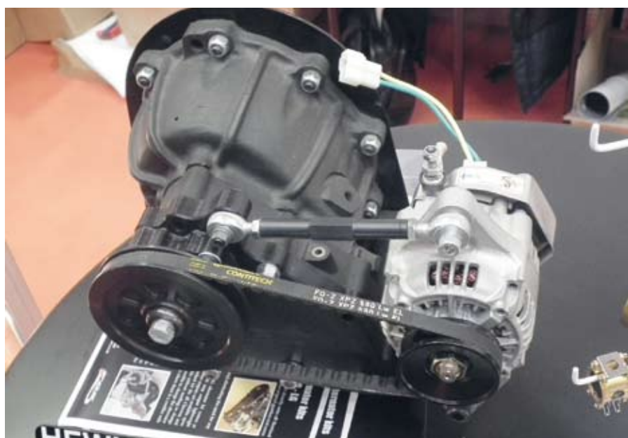
Differenciálműre szerelt generátor
