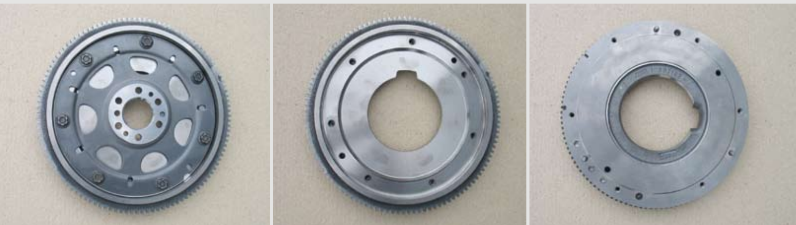
1 A flexibilis lendítőkerék szerkezeti elemei
