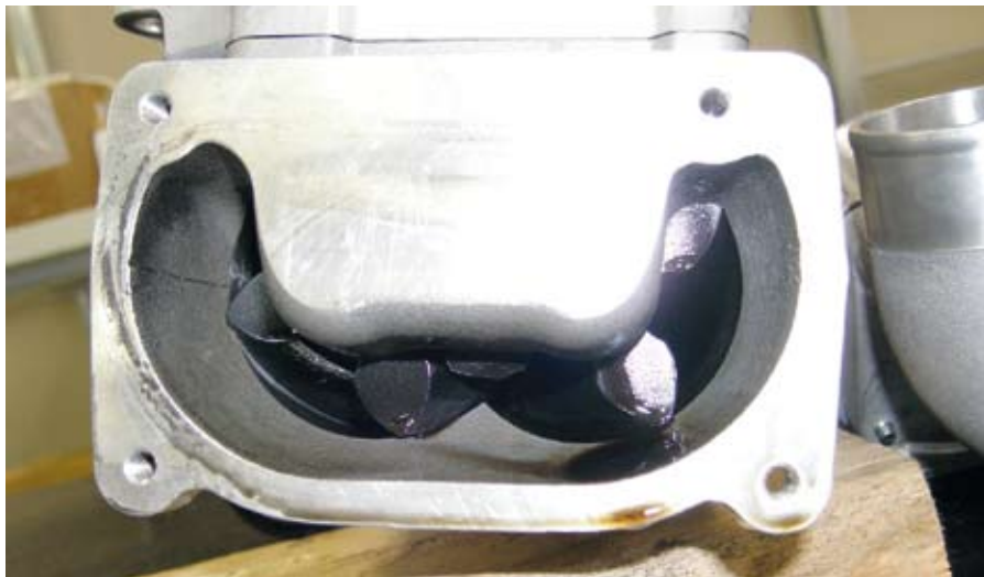
2 A csavarkompresszor levegő-belépési oldala
