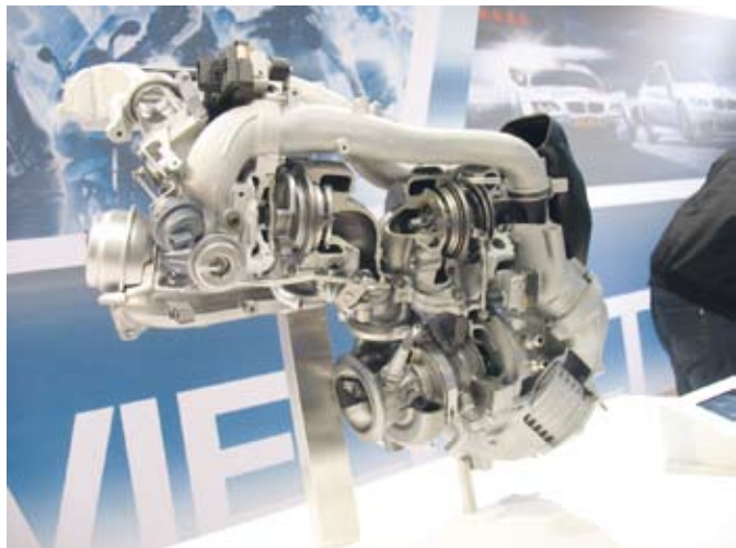
2 A turbófeltöltő modul, mely egyben szerelhető fel a motorra
