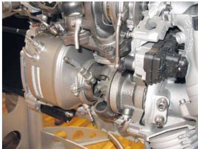
4 A kisnyomású B2-es feltöltő öntvényén elhelyezett lambdaszonda, a katalizátoron található 2 hőmérsékletszenzor és a torlónyomás kivezetése az érzékelőhöz
