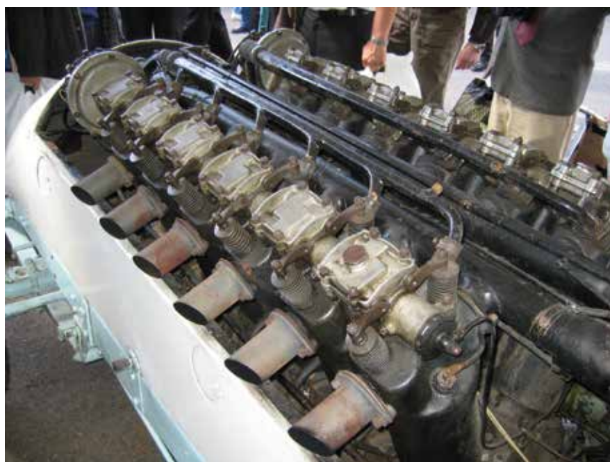
27 059 cm 3 (27 literes!), American Liberty V12-es, 4 karburátoros repülőgépmotor, lánchajtás, Benz sebességváltó, tömege 1780 kg
