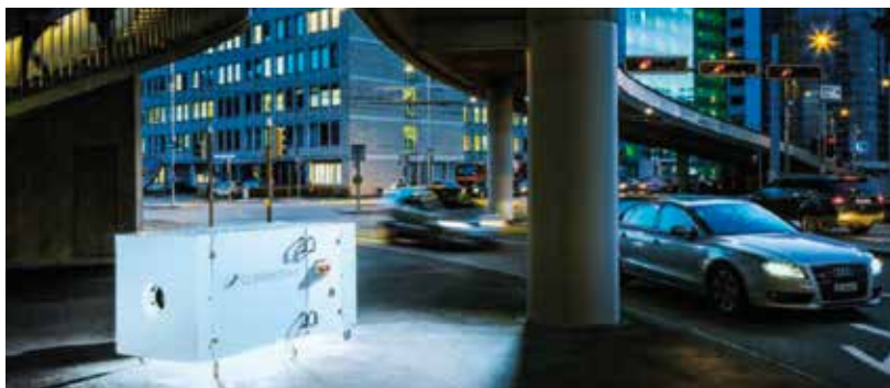
A Climeworks cég légtörő CO 2 befogó modulja és a készülék felépítése. A légtörő szén-dioxid anyagszálak felületén kémiaiag szelektíven kötődik, adszorbeálódik.
