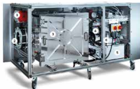
A Climeworks cég légtörő CO 2 befogó modulja és a készülék felépítése. A légtörő szén-dioxid anyagszálak felületén kémiaiag szelektíven kötődik, adszorbeálódik.
