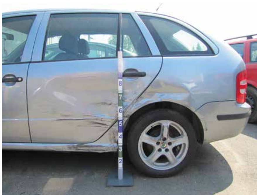
Mérőléces fotózás, a gépjárművön fellelhető károk elhelyezkedésének meghatározására. A károkozó jármű méreteire ad utalást.
