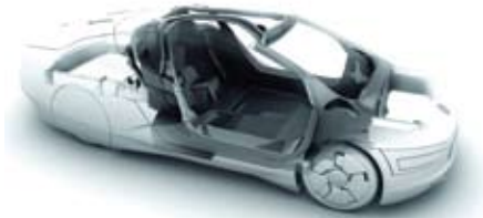
A VW XL 1-es prototípusának kocsiszekrénye (felül), szén-szál-erősítésű héjvázra épül
